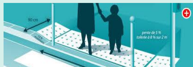
Traversée piétonne , avec bateau , bande d'éveil de vigilance et potelets de protection
